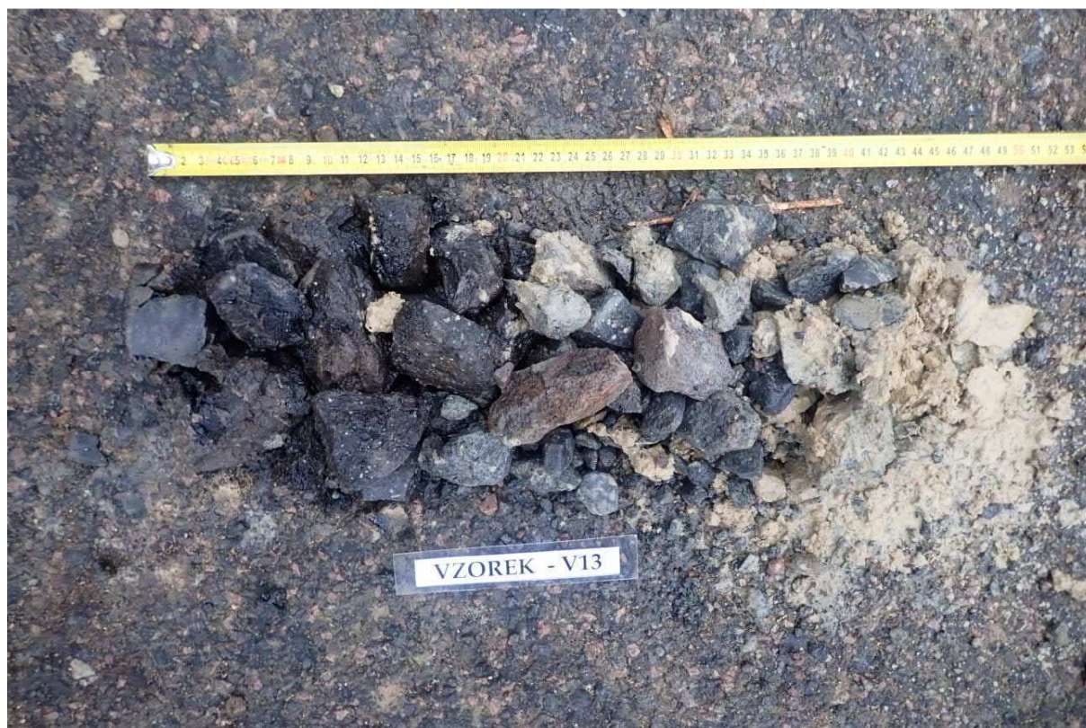
Obr. 25 - Jádro vývrtu Vzorek – V13 (in situ).
