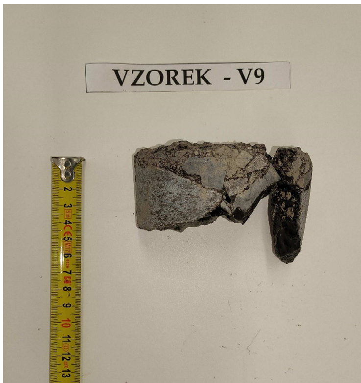
Obr. 18 - Jádro vývrtu Vzorek – V9 (laboratoř).
