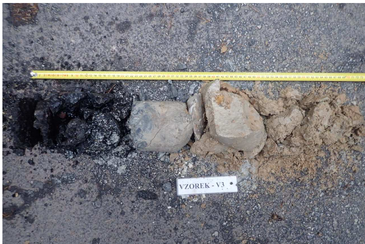
Obr. 5 - Jádro vývrtu Vzorek – V3 (in situ).
