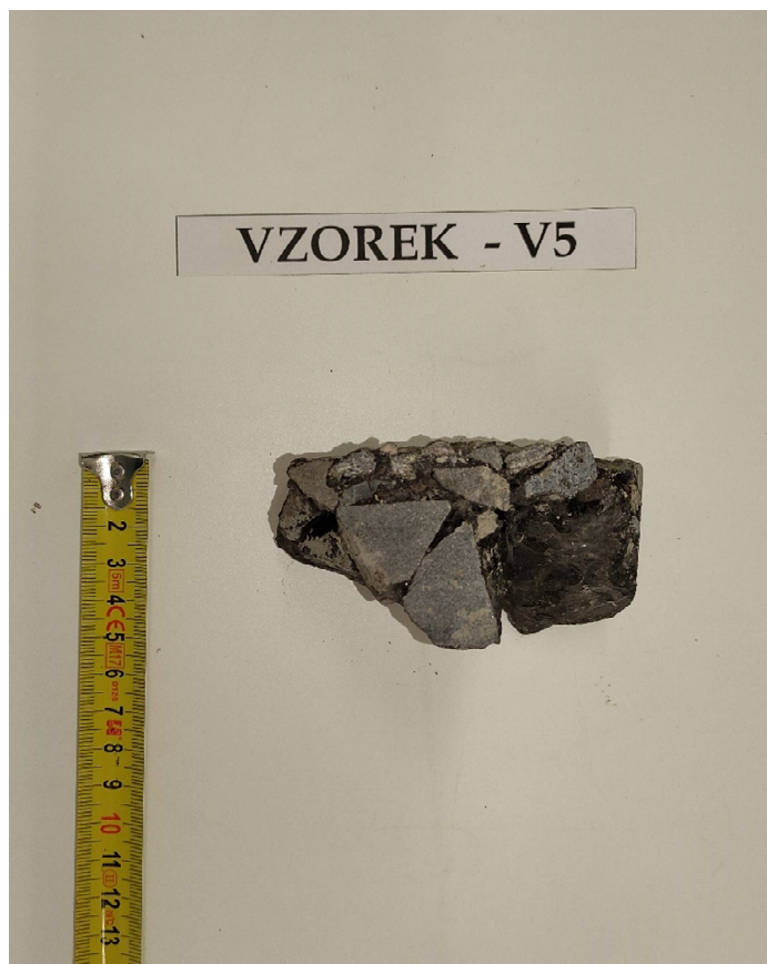
Obr. 10 - Jádro vývrtu Vzorek – V5 (laboratoř).
