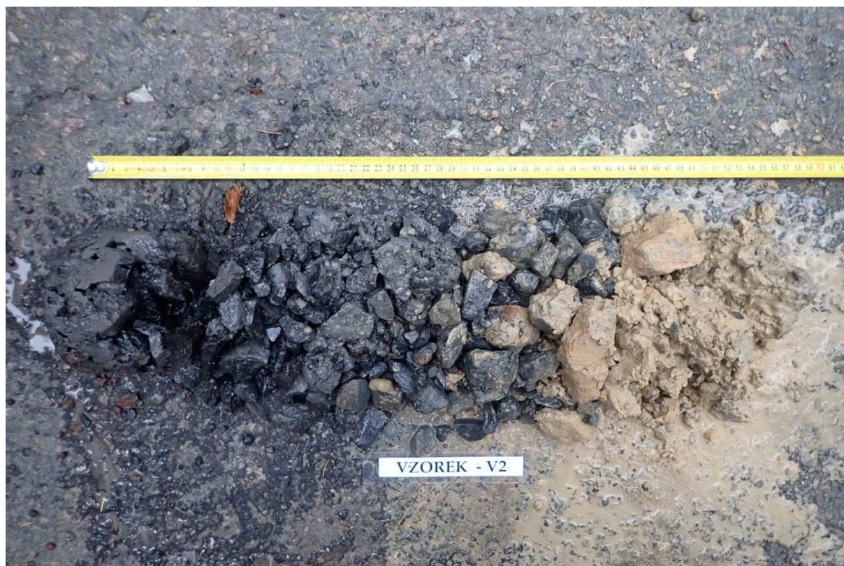
Obr. 3 - Jádro vývrtu Vzorek – V2 (in situ).
