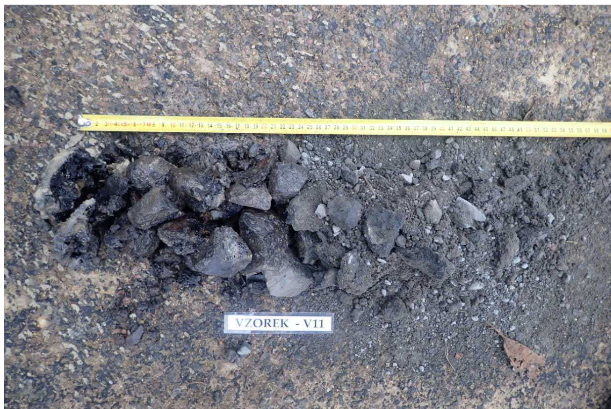
Obr. 21 - Jádro vývrtu Vzorek – V11 (in situ).
