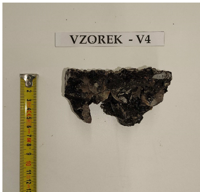
Obr. 8 - Jádru vývrtu Vzorek – V4 (laboratoř).
