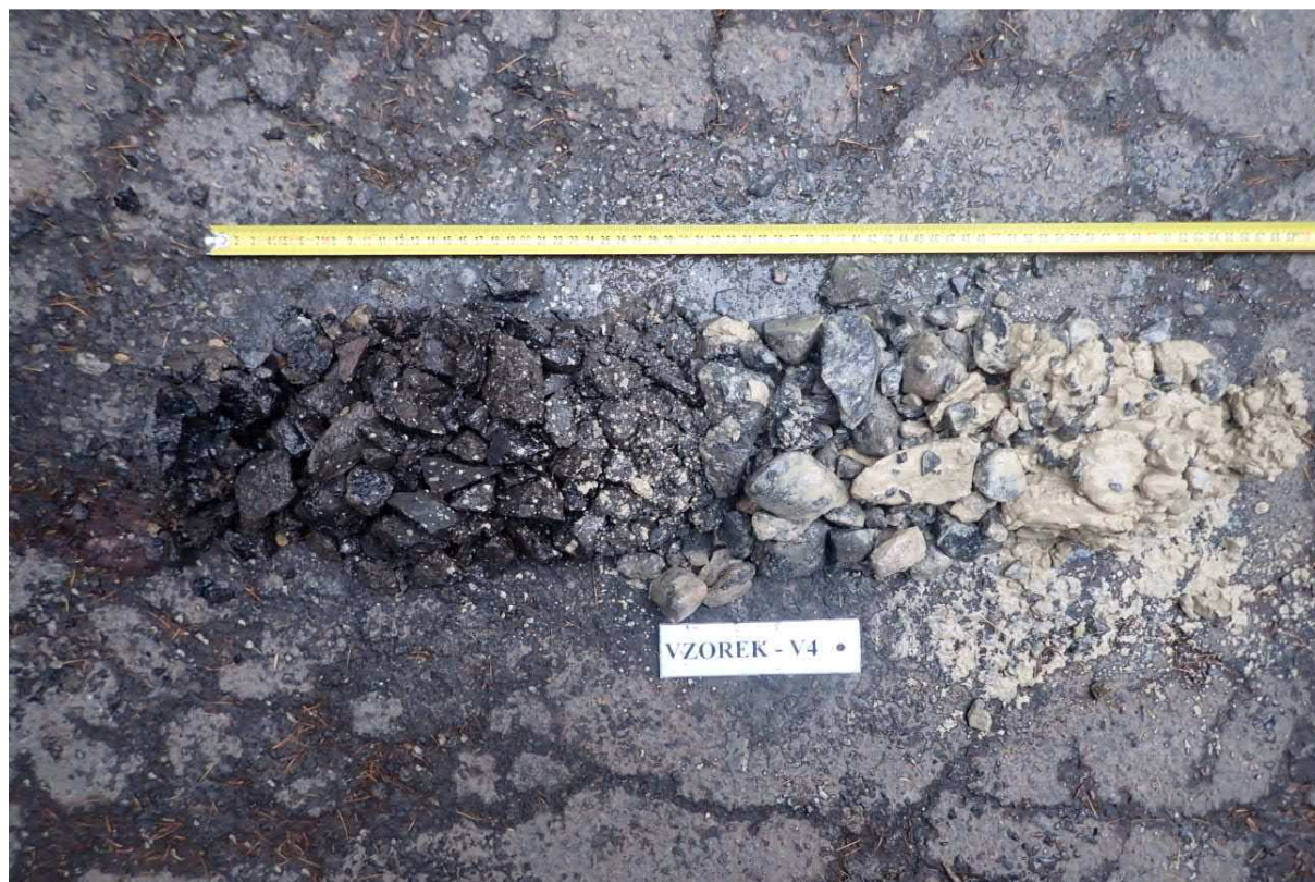
Obr. 7 - Jádro vývrtu Vzorek – V4 (in situ).
