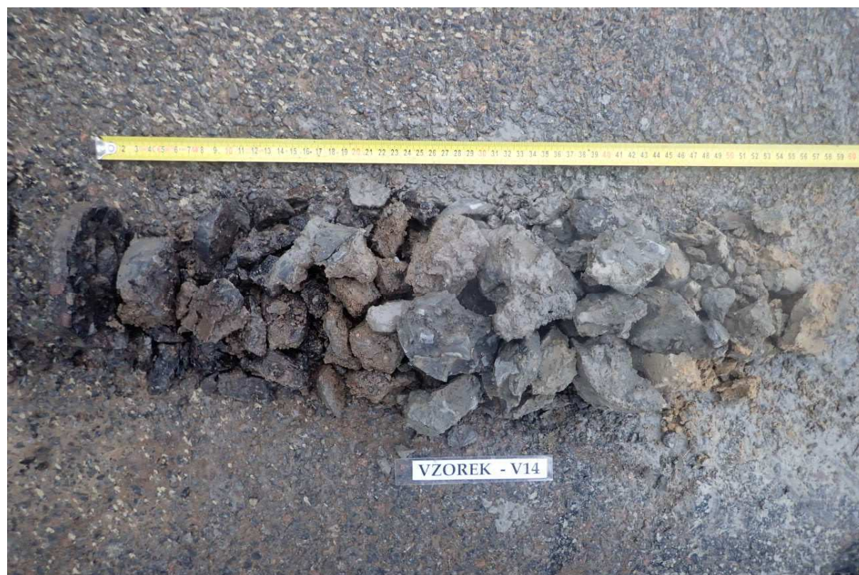
Obr. 27 - Jádro vývrtu Vzorek – V14 (in situ).
