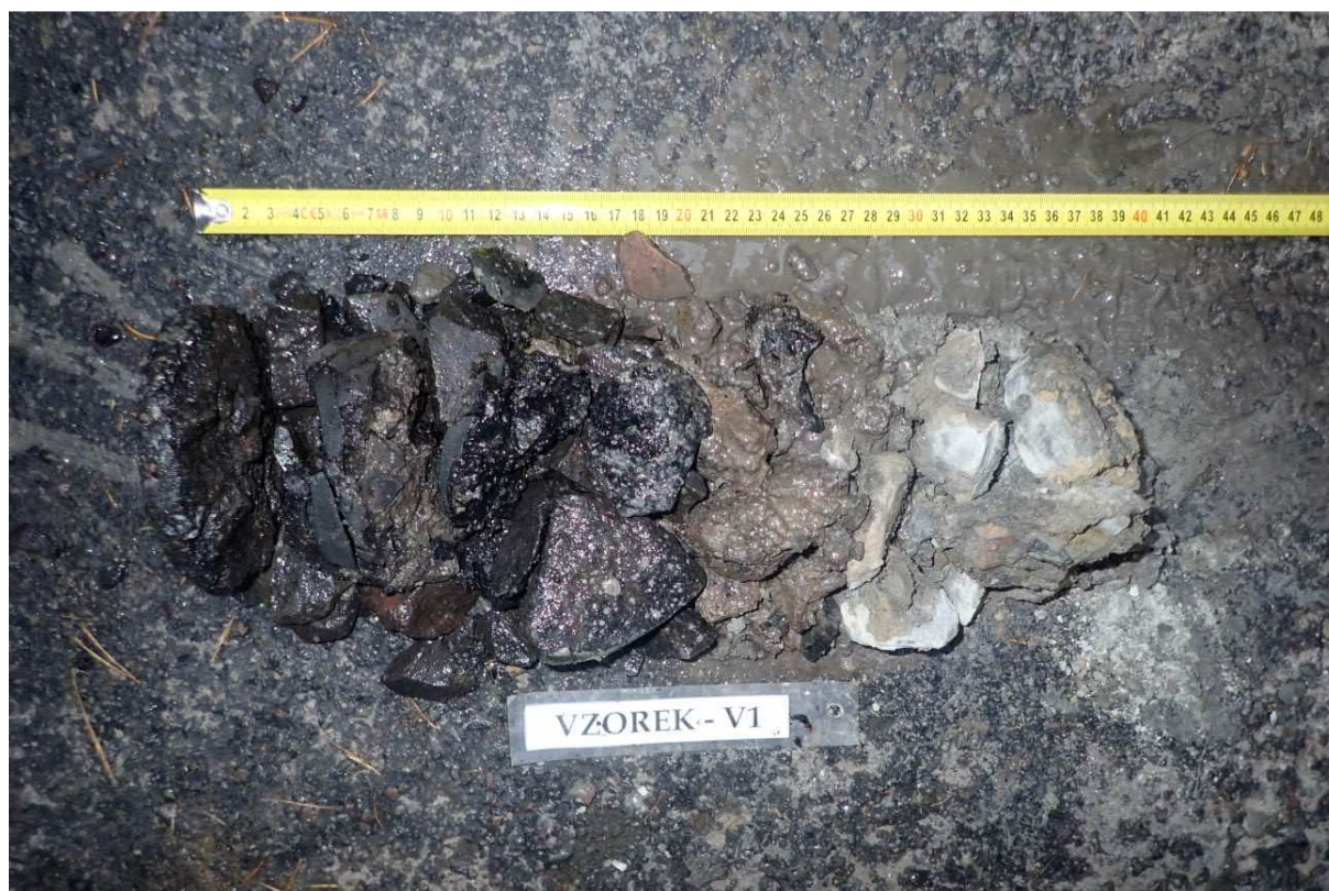
Obr. 1 - Jádro vývrtu Vzorek – V1 (in situ).
