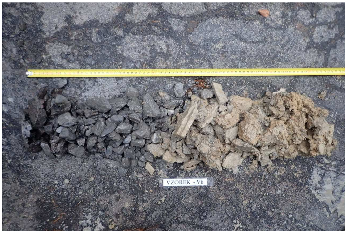
Obr. 11 - Jádru vývrtu Vzorek – V6 (in situ).
