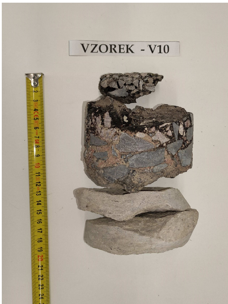
Obr. 20 - Jádru vývrtu Vzorek – V10 (laboratoř).
