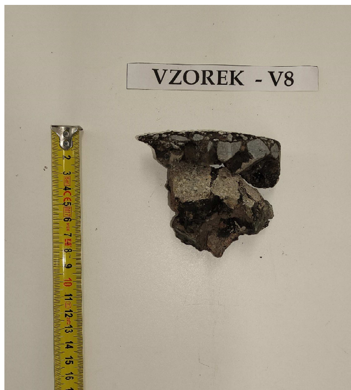
Obr. 16 - Jádro vývrtu Vzorek – V8 (laboratoř).
