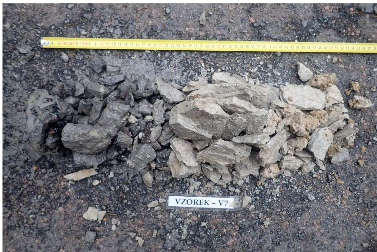
Obr. 13 - Jádru vývrtu Vzorek – V7 (in situ).
