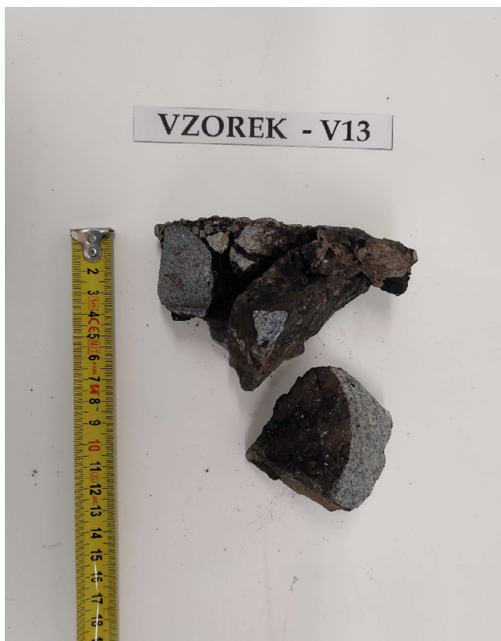
Obr. 26 - Jádru vývrtu Vzorek – V13 (laboratoř).
