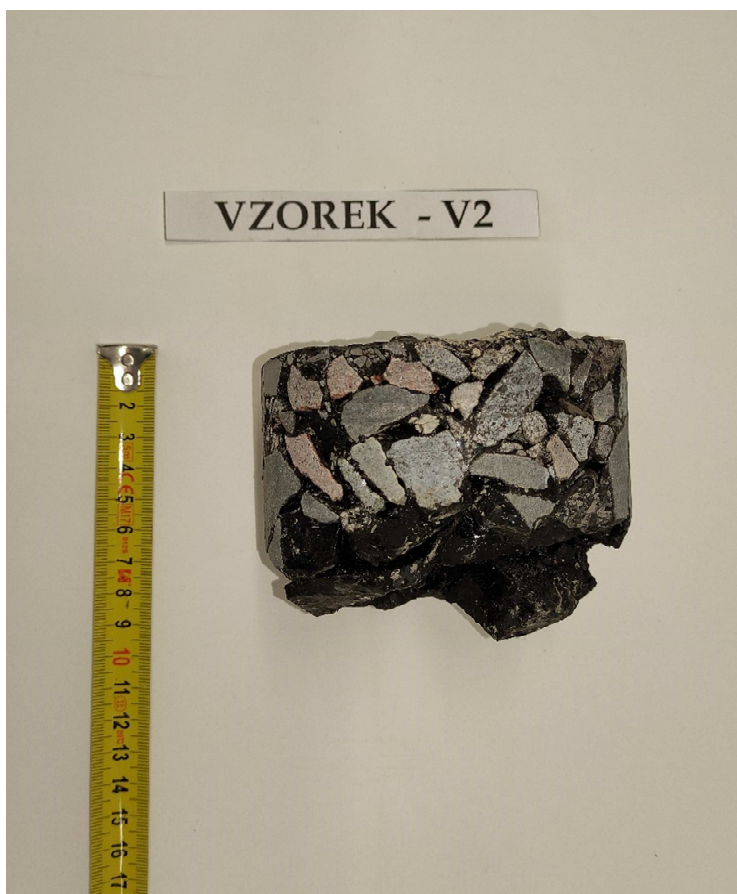
Obr. 4 - Jádru vývrtu Vzorek – V2 (laboratoř).
