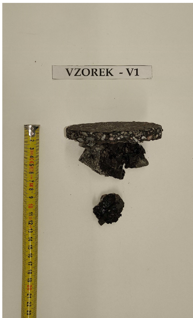
Obr. 2 - Jádru vývrtu Vzorek – V1 (laboratoř).
